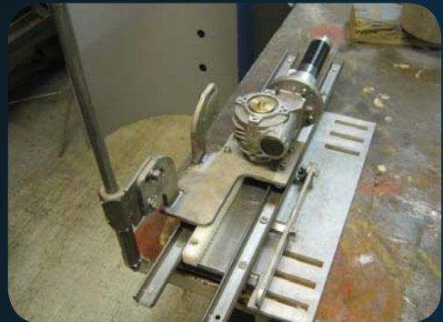
H-bjelke kutteverktøy. Regulerbar i flere posisjoner. Pneumatisk drift.
