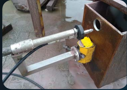
Verktøy for hullskjæring med pneumatisk drift og trinnløs justering. Diameter fra 200 mm - 1200 mm.
