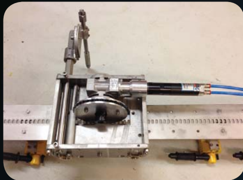
Flexiskinne med skjærevogn. Pneumatisk drift. Festes med magnet, klemmer eller stropper.
