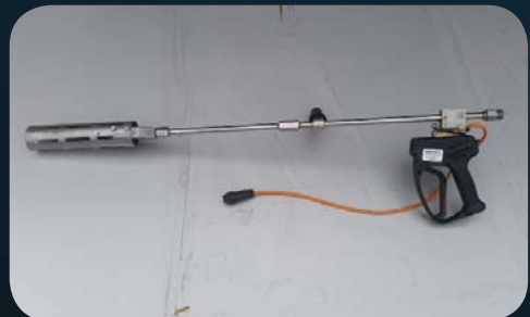
Abrajet spylepistol for våtsandblåsing.
